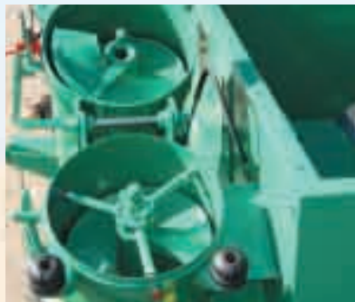
Großer Schneckendurchmesser, Mittenlagerung
