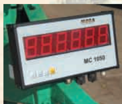
Wiegecomputerdisplay für die Traktorkabine
