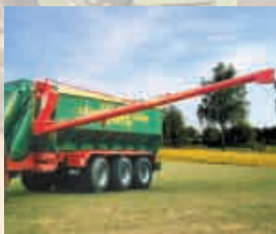
Hydraulisch schwenkbare Saatgutrutsche für Maschinen über 6 Meter Arbeitsbreite
