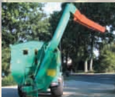
Hydraulisch verstellbare Saatgutrutsche für Drillmaschinen bis 6 Meter Arbeitsbreite
