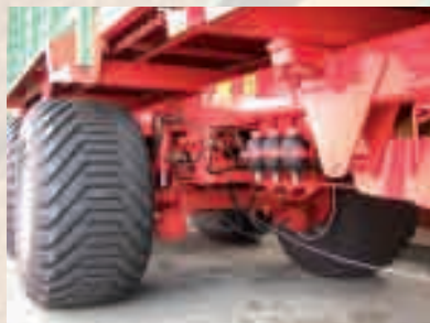
Tandem-Fahrwerk mit hydraulischer Fahrwerksfederung und Twist-Lock System
