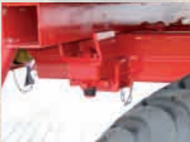
Twist-Lock Verriegelung mit Aufnahme für die Abstellstützen
