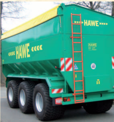
Ein- und Ausrollen der Plane vom Boden aus (ab ULW 1500E serienmäßig)
