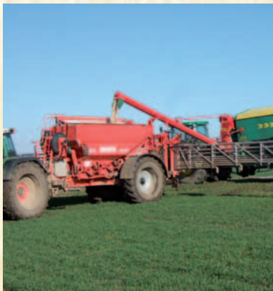
Zusätzliche Auslastung der Überladewagen bei der Düngung. Das Befüllen der großen Streuer erhöht die Leistung und spart Zeit.
