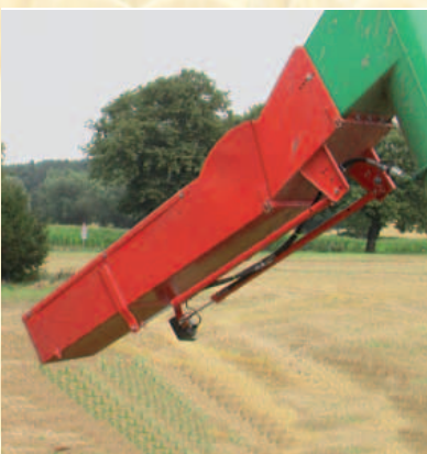
Hydr. verstellbare Saatgut- und Düngerrutsche für große Drillmaschinen und Düngerstreuer
