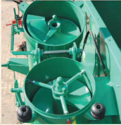
Großer Schneckendurchmesser mit Sternlagerung
