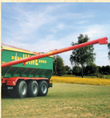
Hydr. schwenkbare Saatgut- und Düngerschnecke für Drillmaschinen und Düngerstreuer mit größeren Arbeitsbreiten
