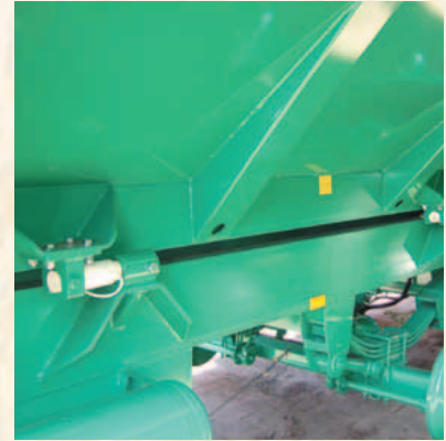
Wiegestäbe für die Wiegeeinrichtung oder integriert im hydraulischen Fahrwerk (Optionen)
