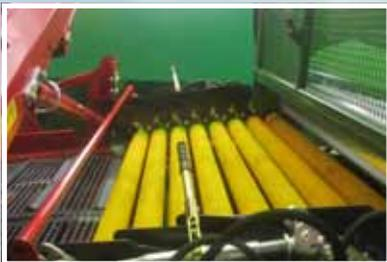
Der **verstellbare Walzenabstand** am Walzenseparator optimiert die Reinigung des Ernteguts. Durch den variablen Neigungswinkel lässt sich die Reinigungsleistung bzw. die Überladegeschwindigkeit individuell einstellen. Die Reinigung der Walzen erfolgt über eine Schnelllauffunktion.
