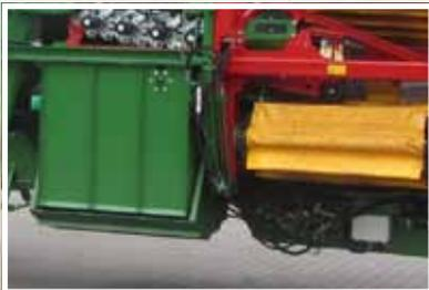
Der **Auffangkasten** für Abrieb bietet bis ca. 3,0 m<sup>3</sup> Volumen. Über zwei Auswurflappen wird der Bunker entleert.
