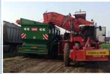
Der aufgesetzte Behälter aus Stahlblech ist mit einem **Rollboden** mit stabiler Förderkette und verzinkten Stahlleisten ausgestattet. Der Querelevator ist 1200 mm breit und ermöglicht eine Entladeleistung von bis zu 120 t/h.
