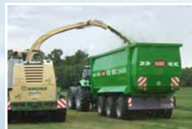
HAWE CSW 5000 mit parabelgefedertem Tridem-Fahrwerk mit Nachlauf-Lenkung für die erste und die dritte Achse, Zwangslenkung optional.
