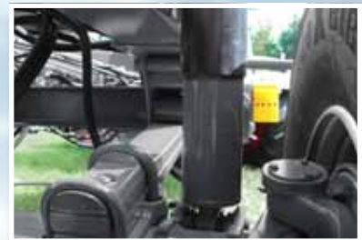
Fahrwerk mit hydraulischer Fahrwerksfederung.
