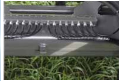
Schmierleiste an den Achsen. Zusammenführung der Schmierstellen an einer zentralen Position.
