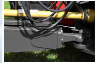
Ansteuerung der Zwangslenkung durch Bowdenzug.
