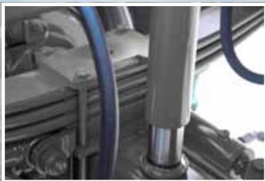
Hydraulische Hinterachsabstützung serienmäßig bei allen Modellen.
