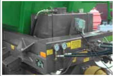
Ölversorgung über Bordhydraulik mit elektrohydraulischer Bedienung.
