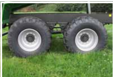
Serienmäßig schweres Parabelfeder-Fahrwerk mit BPW-Achsen und großzügig dimensionierten Bremsen.
