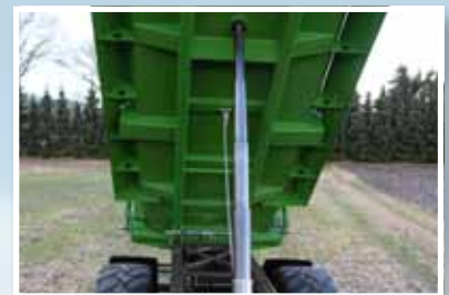
Stabiler Muldenboden auf solider Rahmenkonstruktion.
