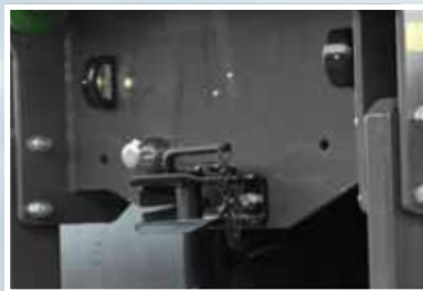
Anhängerkupplung hinten mit Durchtrieb für Hydraulik und Druckluftbremse.
