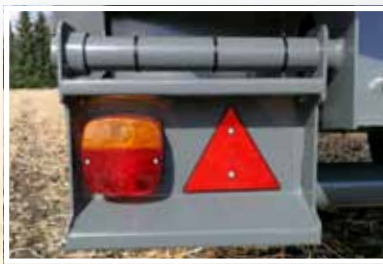
Pendelnd aufgehängte Rückleuchten (Schutzgitter als Zubehör).
