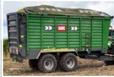
HAWE Cover Laderaumabdeckung mit hydraulischem Antrieb. Für den sicheren, verlustfreien Straßentransport. (Zubehör)
