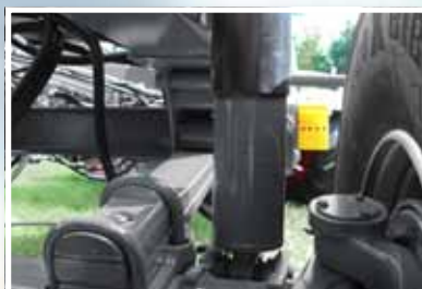
Châssis avec suspension hydraulique .
