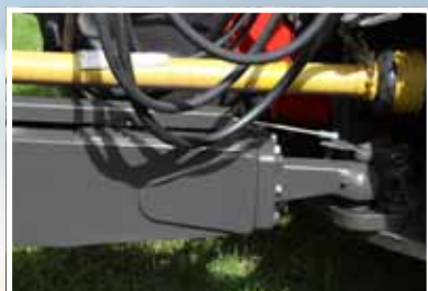
Commande de l'essieu directionnel via un câble Bowden.
