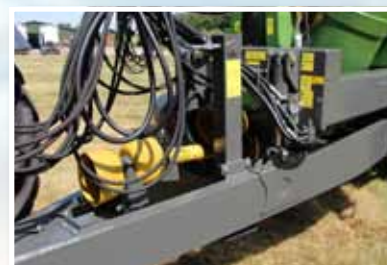
Béquille hydraulique et suspension hydraulique du timon.
